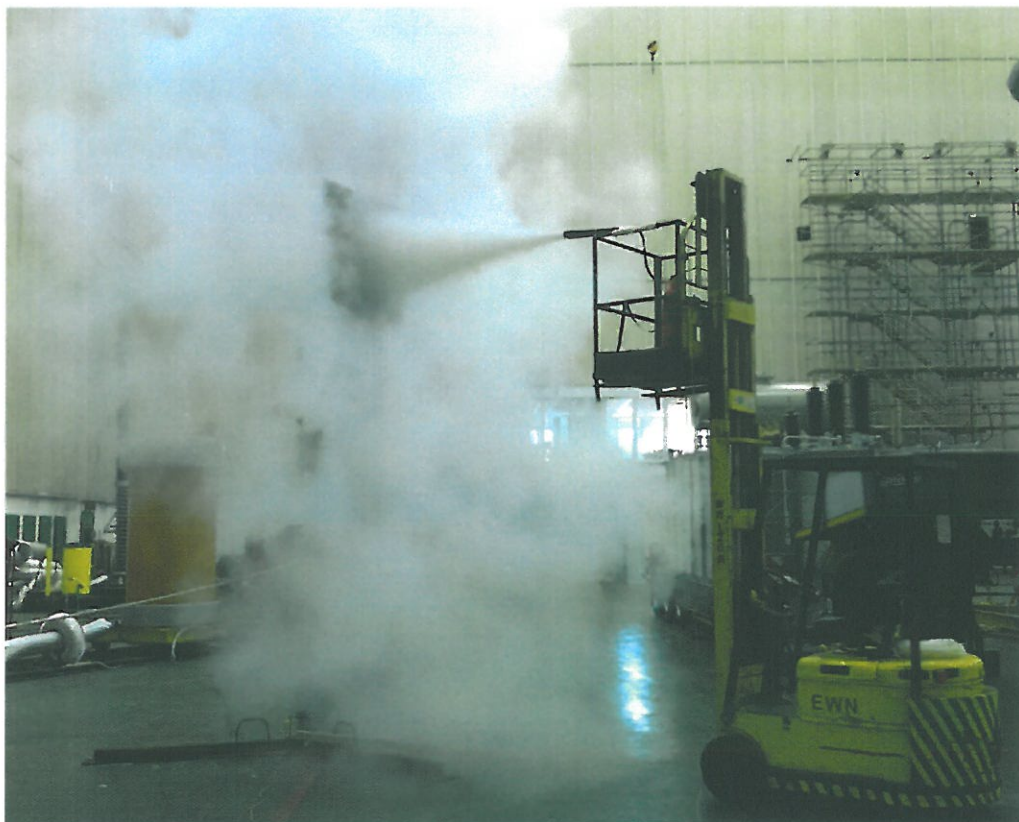
Fot. 2: Badanie wytrzymałości elektrycznej na przebicie chmury CO 2 .
